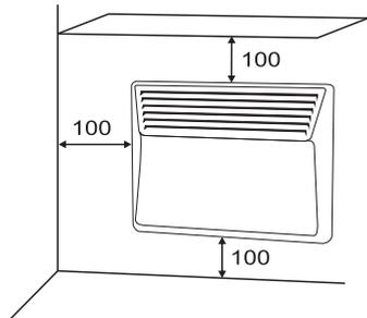
Соблюдайте минимальные расстояния установки на полу, поверхностях, мебели и т.д. (размеры в мм).
